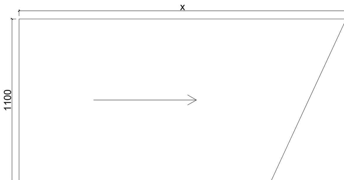
Les panneaux composite alu LEVEL ont un revêtement noir et mat. Ce revêtement est protégé par un film. Posez les panneaux de manière à ce que les flèches sur le film pointent de gauche à droite lorsque vous regardez le toit de face.
