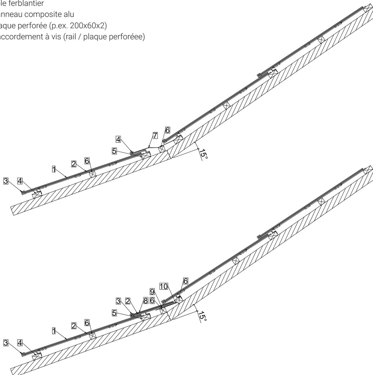
Ruptures de toit possibles de 1° à 90°.
