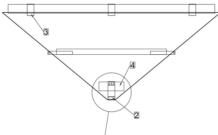
Une surface d'appui pour les crochets-rail d'au moins 80 mm est nécessaire.
