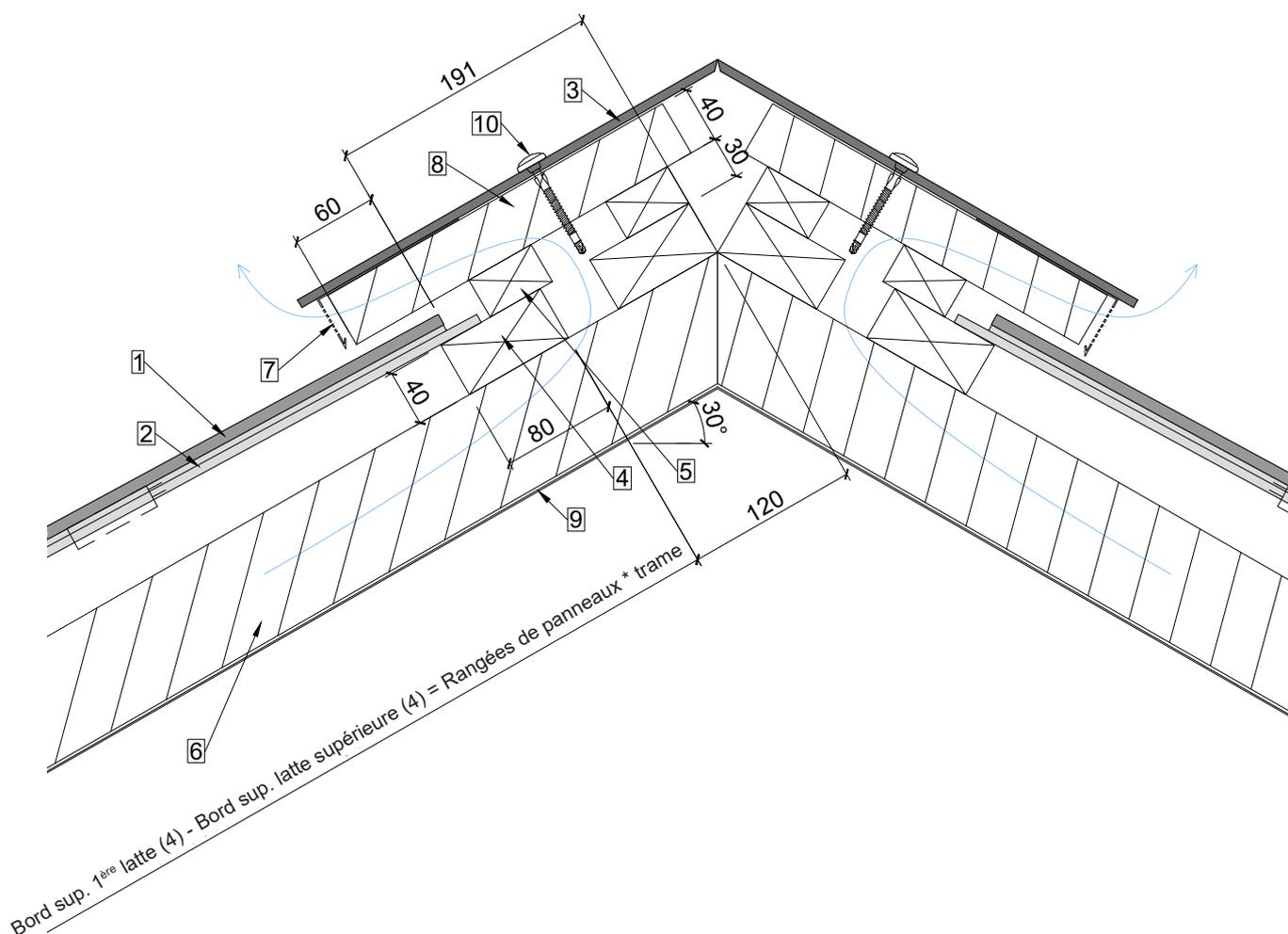
Sécurisation de la rangée supérieure de panneaux incombant au client.
