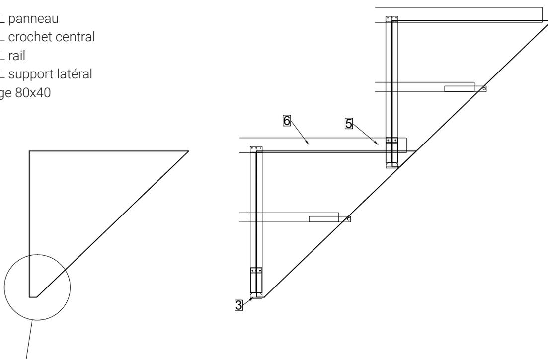
Une surface d'appui pour les crochets-rail d'au moins 40 mm est nécessaire.
