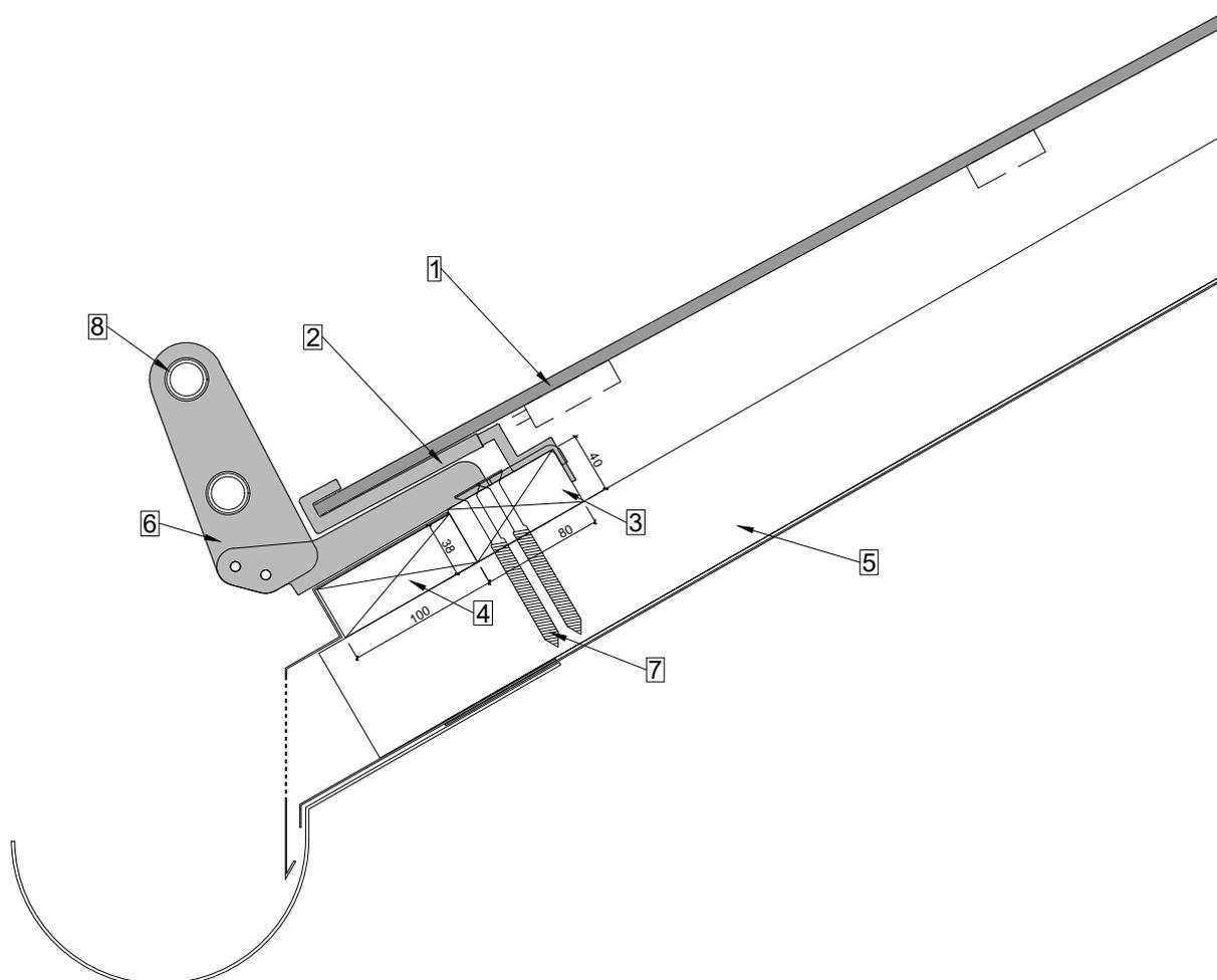
Crochet à neige SEP est placé sous chaque crochet et vissé dans le contre-lattage.
