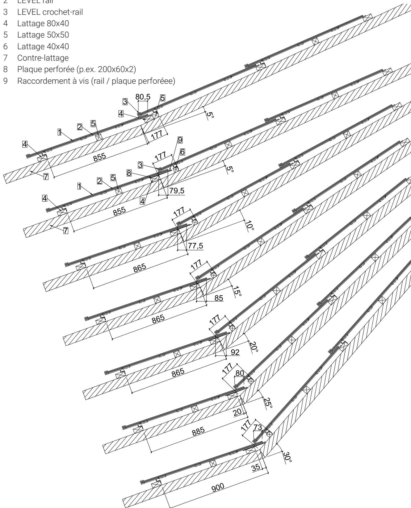
Des ruptures de toit supérieures à 30° sont également possibles.
